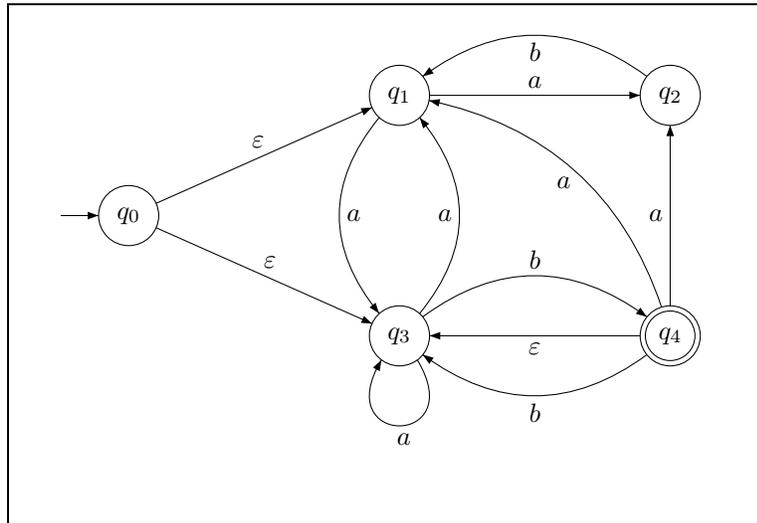
FIG. 3 – Automate à déterminer
